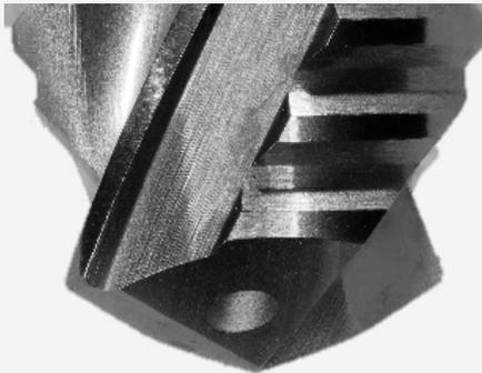
Abbildung 4 (oben): Veränderung des Spiralwinkels am Werkzeug (Quelle: Hoffmann SE)
