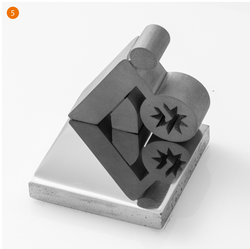
Beispielhafte Darstellung unterschiedlicher Polierstufen bei Chrom-Nickel Stahl unter Einsatz von GARANT CaraFin.
