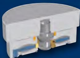
La purge du flexible d'air permet au ZEROCLAMP de positionner la pièce contre la face d'appui sous une force de serrage de 25 kN (répétabilité 5 µm).
