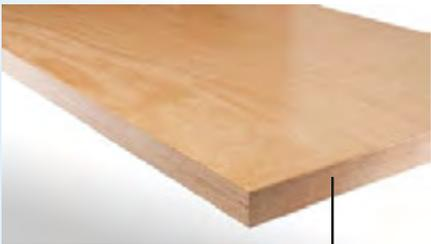
Plan de travail pour un **usage général**. En placage de bois de hêtre raboté, collé, résistant à l'eau, robuste et contreplaqué multicouche. Les angles sont abattus, la surface est rectifiée et recouverte d'un vernis UV incolore. Le **hêtre multiplis** résiste aux projections d'eau, à la saleté et est insensible à l'huile, à la graisse, aux solvants et aux produits chimiques (ces facteurs influencent toutefois l'aspect de la surface).
