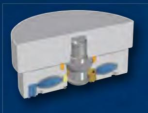
Les éléments ressorts maintiennent l'unité de verrouillage (coins) ouverte sous l'effet de l'air comprimé (5 bars).
