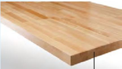
Plan de travail pour travaux lourds, p. ex. dans la **construction mécanique ou métallique**. En bois de hêtre massif (avec profil denté sur le côté long), collé et étanche à l'eau. Les angles sont abattus, la surface est rectifiée et recouverte d'un vernis UV incolore. Les **plans en hêtre** résistent aux projections d'eau, à la saleté et sont insensibles à l'huile, à la graisse, aux solvants et aux produits chimiques (ces facteurs influencent toutefois l'aspect de la surface).
